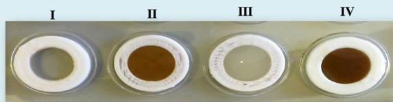
Figure 3. Varies hydrogels I.CS II.CS+5-ASA III.CS+MMT IV.CS+MMT+5-ASA
